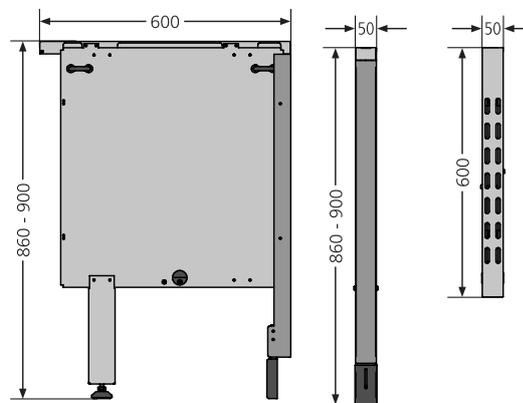
Auf der gewünschten Seite muss man zuerst zwei Schrauben im oberen Teil der Seitenwand heraus-schrauben, um die Seitenwand zu demontieren. Dann die Brandschutzeinheit zu der Seitenwand des Herdes zulegen und an dem Herd an der gleichen Stelle zuschrauben. Zu der Brandschutzeinheit gehören einstellbare Schrauben und ein einstellbarer Hinterfuß. Damit kann man die gewünschte Höhe anpassen.
