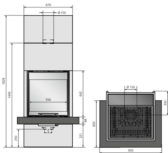
\* **Achtung:** Maßangabe des Anschlusses für externe Verbrennungsluft auf Anfrage. Bohrung bitte erst bei Lieferung des Gerätes!
